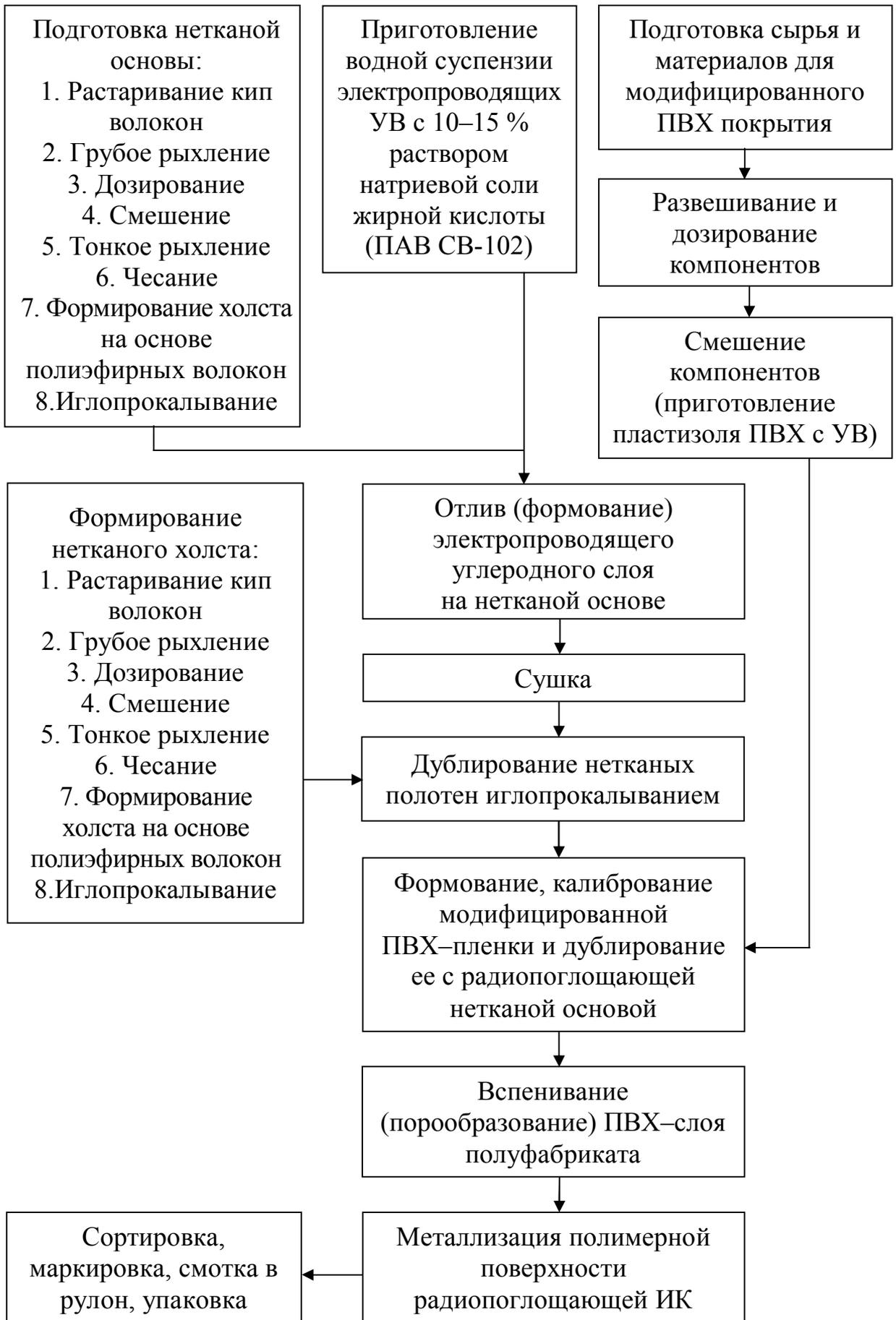
**Рисунок 5.3 – Блок–схема производства радиопоглощающих ИК**
