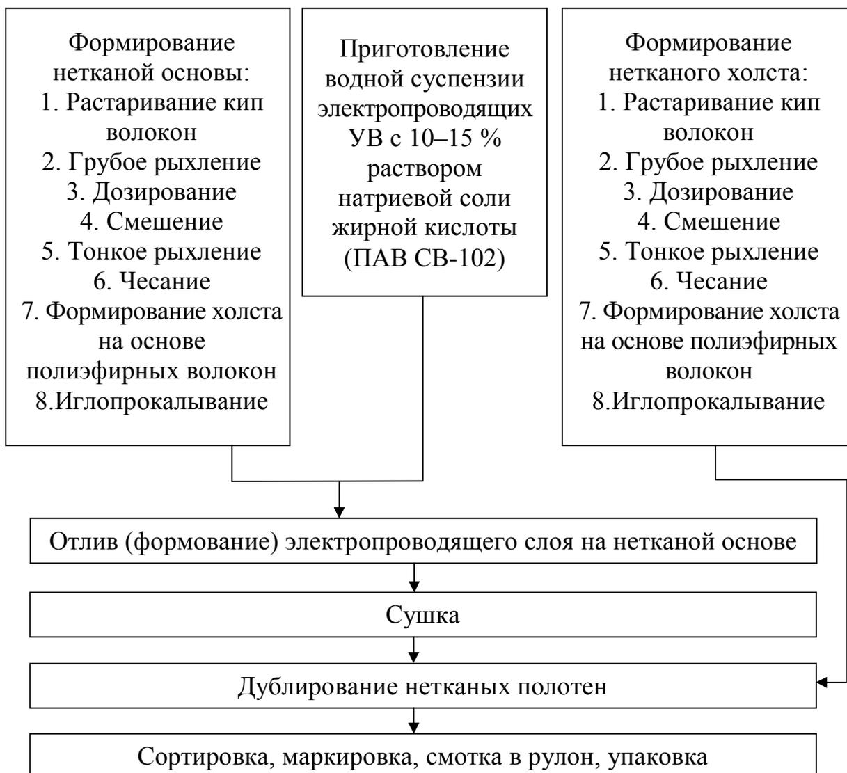
**Рисунок 5.1 – Блок–схема производства нетканых РПМ**
